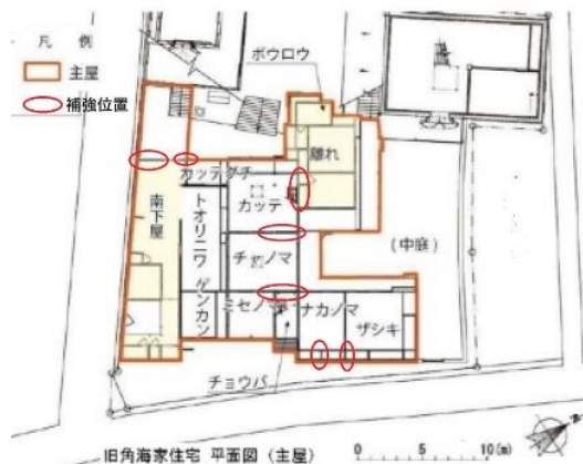
図 2 角海家 平面図、耐震改修位置 記入 by 日経 Xtech
